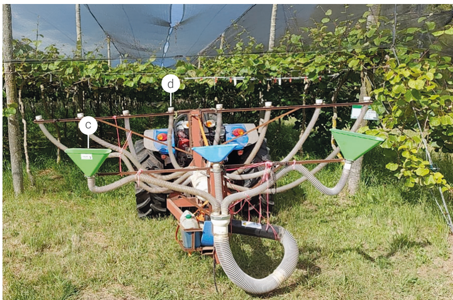
Figura 18. Máquina polinizadora con el método seco. c: estructuras en forma de cono que absorben el aire circundante con polen que queda disperso en el ambiente luego de haber sido aplicado. d: difusor. Fuente: Laureano Goycoa.
