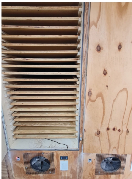
Figura 12. Horno con bandejas extraíbles para secar las anteras de las flores masculinas. Fuente: Jorge Lozano Miglioli.
