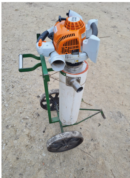
Figura 13. Aspiradora para extraer polen luego del secado de las anteras. Fuente: Jorge Lozano Miglioli.
