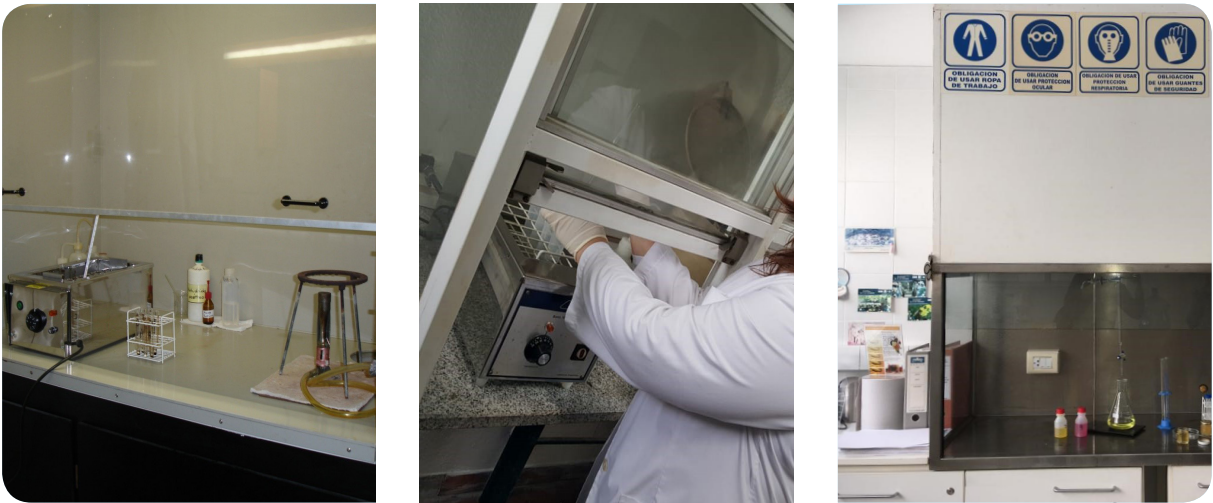
14 > Campana extractora de gases, empleada para acetólisis
